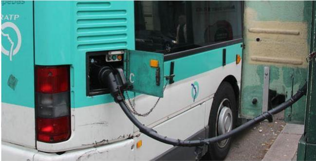
Rechargement d'un Oréo 55E au terminus de la ligne Montmartrobus pour prolonger l'autonomie
